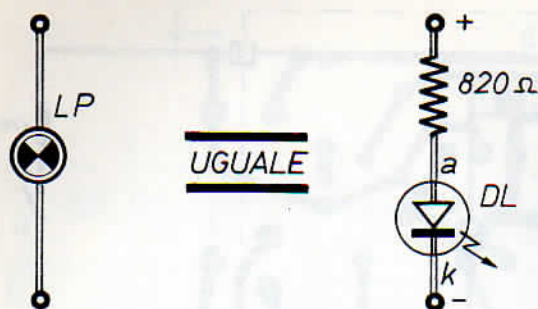
Fig. 5 - Le lampade LP, inserite nel progetto semplificato, possono essere sostituite con i diodi led, collegati ad una resistenza da 820 ohm in serie.
