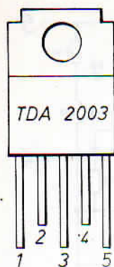
Fig. 5 - Piedinatura dell'integrato TDA 2003, che deve essere munito di aletta di raffreddamento, come segnalato nello schema del piano costruttivo e nella foto di apertura del presente articolo.
